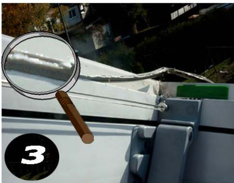
Defekten Gummi vollständig entfernen, und die Nut reinigen.
